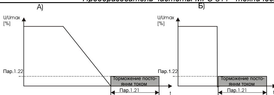
Рис. 7.4 Торможение с помощью постоянного тока а) остановка „рампа” [„ramp”] б) остановка „выбег” [„wybieg”]
